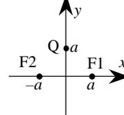
Ai vertici di un triangolo equilatero di lato  $a$ , disposto sul piano  $xy$  come in figura, si trovano due fili rettilinei indefiniti uniformemente carichi F1 ed F2 (perpendicolari al piano  $xy$ ) e una carica puntiforme  $Q$ . I fili F1 e F2 hanno stessa densità lineare di carica  $\rho_L > 0$ . Determinare la forza (modulo, direzione e verso) che si esercita sulla carica  $Q < 0$ .
