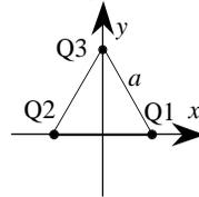
Due cariche puntiformi  $Q_1$  e  $Q_2$ , di carica opposta ( $Q_1 = -Q_2$ ,  $Q_1 > 0$ ) sono disposte sull'asse  $x$  nelle posizioni  $a$  e  $-a$ . Una terza carica  $Q_3$  positiva è collocata sull'asse  $y$ , all'ascissa  $a$ . Determinare la forza (modulo, direzione e verso) che si esercita sulla terza carica. (facoltativo) Cambierebbe il risultato, e come, se le cariche  $Q_1$  e  $Q_2$  avessero carica uguale anche in segno?
