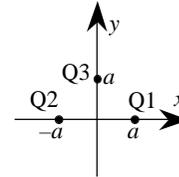
Tre cariche puntiformi sono disposte ai vertici di un triangolo equilatero di lato  $a$ , disposto sul piano  $xy$  come in figura. Le cariche  $Q_1$  e  $Q_2$  sono uguali e positive.  $Q_3$  è negativa. Determinare la forza (modulo, direzione e verso) che si esercita sulla terza carica  $Q_3$ . (facoltativo) Cambierebbe il risultato, e come, se le cariche  $Q_1$  e  $Q_2$  avessero carica uguale in modulo, ma opposta in segno?
