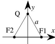
Due fili rettilinei indefiniti F1 e F2, con densità lineare di carica opposta ( $\rho_{L1} = -\rho_{L2}$ ,  $\rho_{L1} > 0$ ) sono disposti perpendicolarmente all'asse  $x$  nelle posizioni  $a$  e  $-a$ . Una carica  $Q$  positiva è collocata sull'asse  $y$ , all'ascissa  $a$ . Determinare la forza (modulo, direzione e verso) che si esercita sulla carica.
