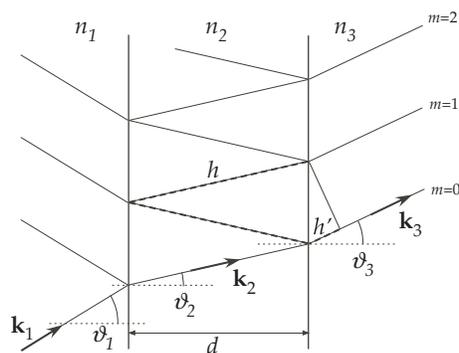
Figure 1: Riflessioni multiple di un'onda piana da strato dielettrico
