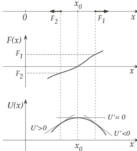
Figure 2: Andamenti di  $F(x)$  e di  $U(x)$  nell'intorno di una posizione di equilibrio instabile.
