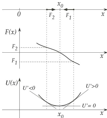
Figure 1: Andamenti di  $F(x)$  e di  $U(x)$  nell'intorno di una posizione di equilibrio stabile.
