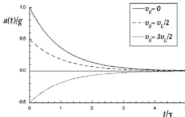
Figure 2: Andamento dell'accelerazione, normalizzata con l'accelerazione di gravità, graficato per diversi valori della velocità iniziale.
