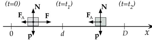
1. La componente  $x$  della risultante delle forze applicate al corpo vale  $F_x^{(\text{tot})} = F - F_A = F - \mu mg$ , per cui la sua accelerazione risulta
