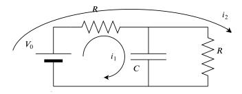
dove  $i_1$  circola nella maglia con in generatore, la resistenza e il condensatore e  $i_2$  circola nella maglia con in generatore e le due resistenze. Usando la legge di kirchhoff sulle maglie otteniamo
