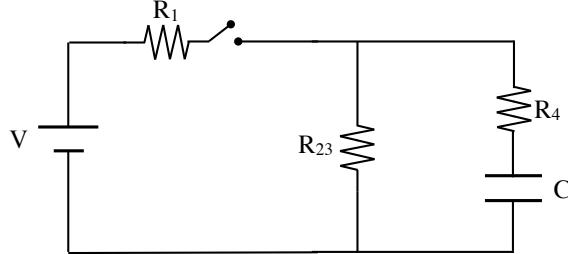
Nella situazione iniziale (interruttore chiuso), nel ramo di circuito contenente il condensatore non scorre alcuna corrente, il condensatore è infatti completamente carico. Essendo sullo stesso ramo del condensatore, neppure attraverso la resistenza  $R_4$  scorre alcuna corrente, ed è dunque nulla la d.d.p. ai suoi capi. La corrente scorre solamente nella maglia di sinistra.
