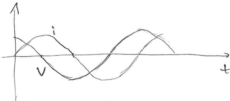
L'energia si trasforma alternativamente da energia elettrica a energia magnetica
