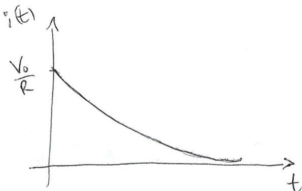
L'energia elettrica  $E = \frac{1}{2} C V_0^2$  inizialmente immagazzinata nel condensatore viene interamente dissipata per effetto Joule fino a che la corrente non va a zero
