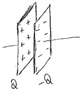
La densità di carica su ogni armatura è pari a  $\sigma = \frac{Q}{S}$  in modulo
