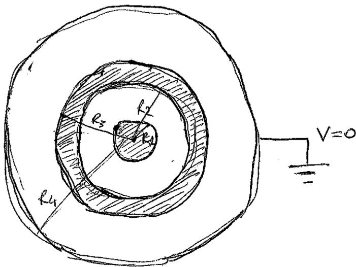
Il sistema equivale a una serie di 2 condensatori sferici
