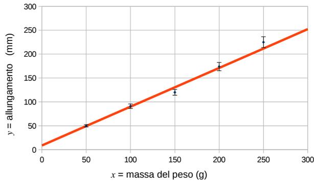
Figura 9.2: Grafico dell'allungamento di una molla in funzione della massa del peso applicato. La retta nel grafico è il fit ai dati ottenuto con il metodo dei minimi quadrati.
