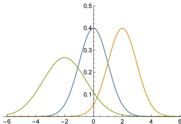
Figura 5.5: Tre distribuzioni di probabilità normali. Partendo da sinistra la prima con  $\mu = -2$  e  $\sigma = 1.5$  la seconda con  $\mu = 0$  e  $\sigma = 1.0$  (variabile normale standardizzata) e la terza con  $\mu = 2$  e  $\sigma = 1.0$ . Si noti che la distribuzione normale è simmetrica e centrata sul suo valore medio. La larghezza della curva è determinata dal valore del parametro  $\sigma$  (*deviazione standard*).
