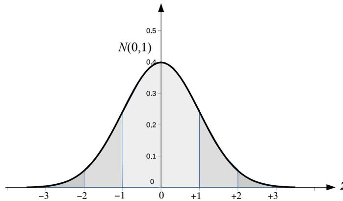
Figura 5.6: Distribuzione della variabile normale standardizzata  $z$ . L'area in colore più chiaro indica  $P(-1 < z < 1) = 0.6826$ , con l'aggiunta dell'area di colore intermedio si ottiene  $P(-2 < z < 2) = 0.9545$  e infine aggiungendo l'area di colore più scuro si ottiene  $P(-3 < z < 3) = 0.9973$ .
