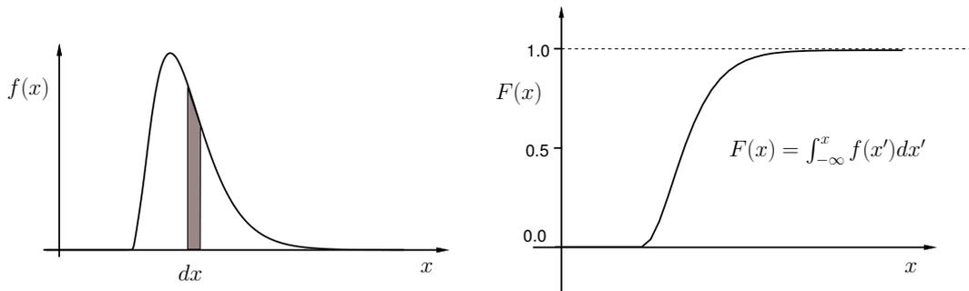
Figura 5.2: Esempio di funzione di distribuzione di densità di probabilità (pdf) per una variabile continua  $x$  (grafico di sinistra). Il grafico di destra è la funzione cumulativa di probabilità relativa alla pdf mostrata a sinistra. Si noti che il valore di  $F(x)$  per  $x \rightarrow \infty$  tende a 1 (certezza).
