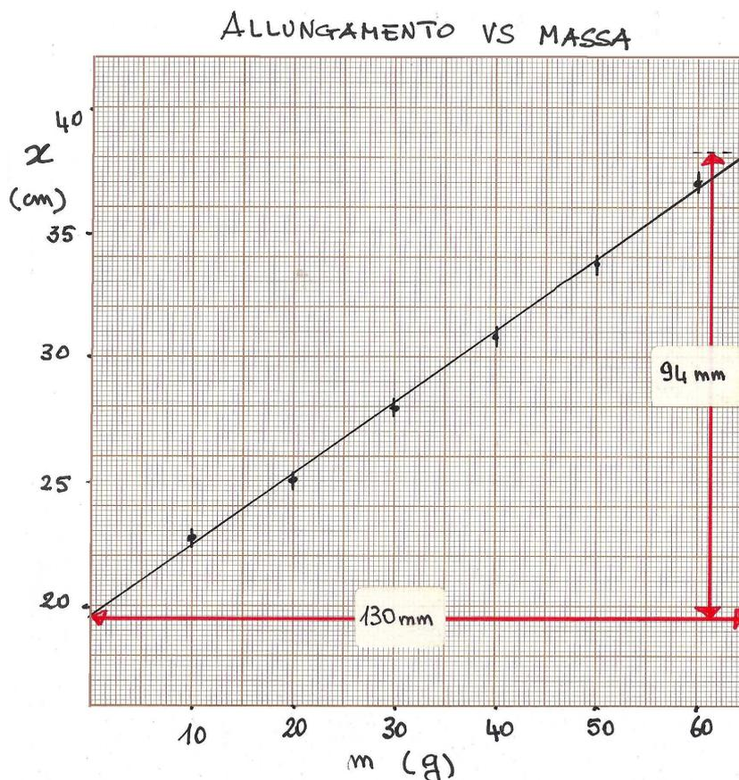
Figura 4.1: Grafico con scale lineari dei dati di tabella 4.1. Nel grafico sono indicate le misurazioni effettuate con un righello millimetrato e quindi rapportate alle scale scelte per la valutazione del coefficiente angolare della retta tracciata. Vedi il testo per ulteriori dettagli.
