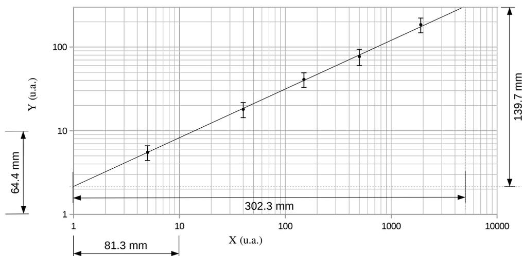
migliore con la tecnica far passare la retta per quanto possibile vicino ai punti. La misurazione del coefficiente angolare della retta è stata eseguita misurando con un regolo millimetrato le distanze indicate in figura. Nella figura sono inoltre indicate le misure della lunghezza delle decadi per i due assi coordinati.
