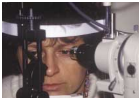
Fig. 11 Lampada a fessura Nikon FS-3 con microscopio endoteliale senza contatto applicato al posto dell'obiettivo del biomicroscopio.
