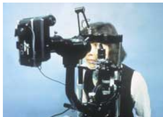
Fig. 10 Lampada a fessura Nikon FS-1 equipaggiata per la tecnica Holden-Zantos. (Per gentile concessione di Holden/Zantos, IACLE Slide Collection)
