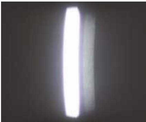
Fig. 14 Per effetto dell'aumento dell'ampiezza della fessura, rispetto alla fig.13, aumenta l'ampiezza delle zone 1 e 3 si restringe la zona 2.
