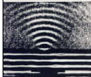
Figura 40-2 Diffrazione da una fenditura delle onde di superficie in una bacinella d'acqua. Da notare che la larghezza della fenditura è circa uguale alla lunghezza d'onda. (Concessione di Educational Services Incorporated).
