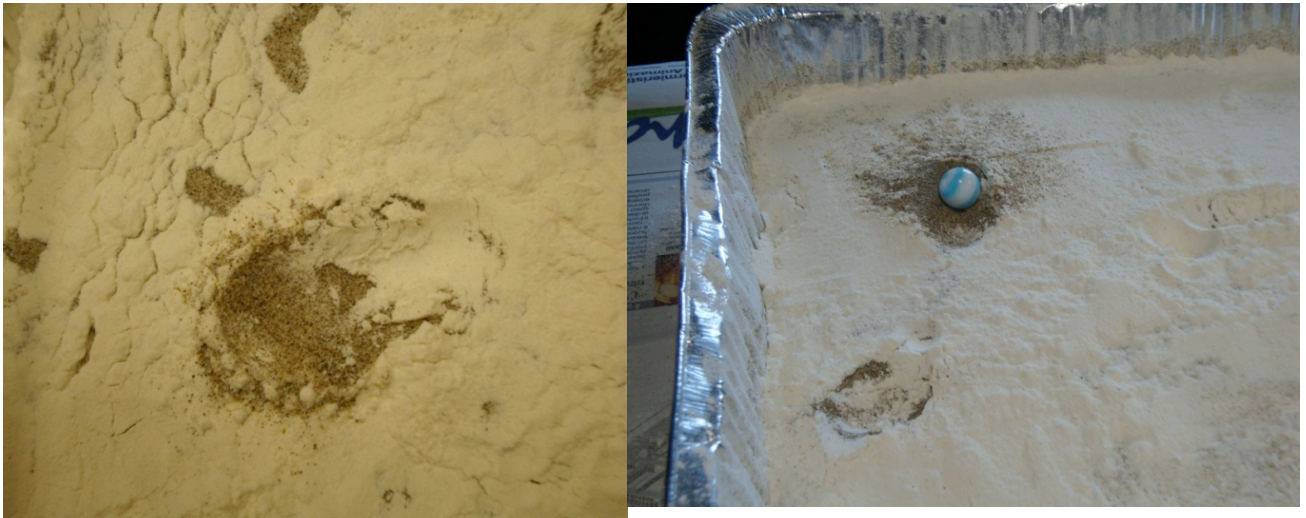
Lanci riprodotti in laboratorio con angolo di circa 45^\circ .
