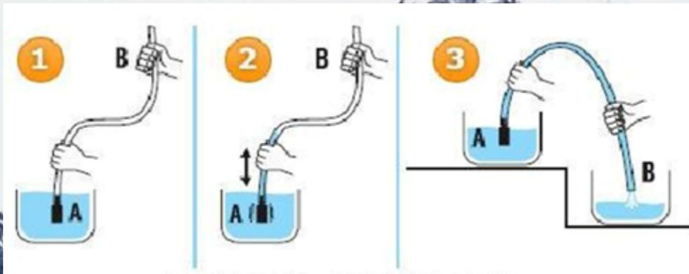
si immette il tubo nel recipiente da cui prelevare liquido e avviene il travaso, perché il liquido nel recipiente posto più in basso cerca di raggiungere lo stesso livello di quello posto più in alto.
