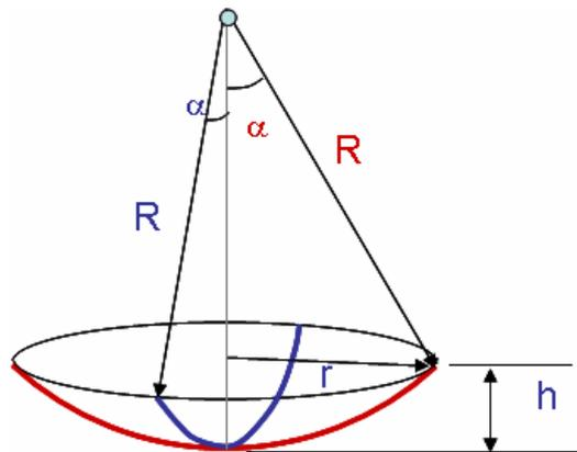
che fa vedere come la risultante verticale delle forze applicate sia inversamente proporzionale ai raggi di curvatura della superficie lungo x e y ( $R_x$  e  $R_y$ ). Nel caso del palloncino la forza  $F_z$  della superficie elastica è diretta verso l'interno, ortogonale alla superficie, e si oppone alla pressione dell'aria che spinge verso l'esterno.
