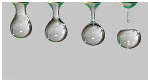
Se ora lasciamo cadere una goccia di detersivo nel bicchierino e ripetiamo l'esperimento cosa osserviamo? Se ora si pesano le gocce di acqua e sapone vediamo che il peso è sensibilmente ridotto anche se questo non può
