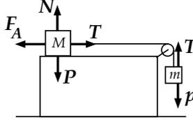
Dalle ultime due relazioni si ottiene:  $F_A = mg$ . Per potersi verificare la condizione di equilibrio, deve essere  $F_A = mg \leq \mu_S N = \mu_S Mg$ , da cui  $\mu \geq m/M$ . La quantità
