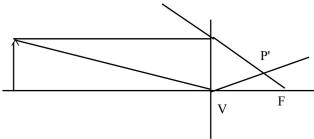
Per costruire l' immagine di un punto P si considerano due raggi uno parallelo all' asse ottico, l' altro passante per V. Il primo viene riflesso in un raggio il cui prolungamento passa per il fuoco; il secondo viene riflesso con angolo di riflessione uguale a quello di incidenza. L' intersezione dei prolungamenti di questi raggi è
