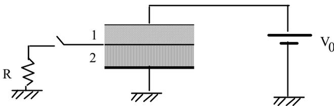
Tra i due dielettrici è inserito un strato metallico di spessore trascurabile. Uno dei capi del condensatore è (da  $t=-\infty$ ) collegato ad un generatore di tensione  $V_0 = 200 \text{ V}$ , l'altro è collegato a terra. Al tempo  $t$
