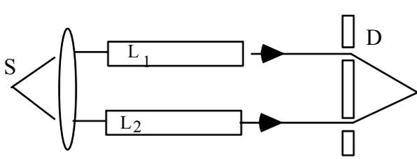
2) Un classico interferometro per la misura di indici di rifrazione di sostanze gassose è mostrato nella figura, in cui  $S$  è una sorgente di luce monocromatica di lunghezza d'onda nel vuoto  $\lambda_0 = 5890 \text{ \AA}$ ,  $L_1$
