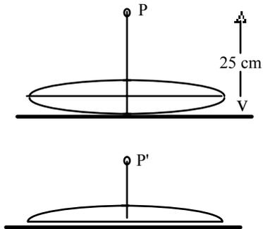
1) Una lente sottile biconvessa è costruita con due calotte di una sfera di materiale di indice di rifrazione  $n = 1.55$ .
