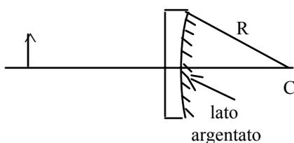
3°. uno specchio deformante è formato da una lente piano-concava di vetro, la cui faccia curva è argentata. Sapendo che il raggio di curvatura della faccia concava è  $R=75 \text{ cm}$  e che l' indice di rifrazione del vetro è  $n=1.50$
