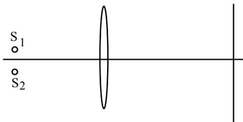
3) Due sorgenti monocromatiche ( $\lambda = 500 \text{ }\mu\text{m}$ ) aventi distanza relativa  $1 \text{ mm}$  sono poste alla distanza  $l = 30 \text{ cm}$  da una lente sottile convergente avente distanza focale  $f = 20 \text{ cm}$ . Trovare la distanza in cm tra la frangia luminosa di ordine zero e quella di ordine 1 che si osservano su uno schermo posto a distanza  $l = 3 \text{ m}$  dalla lente
